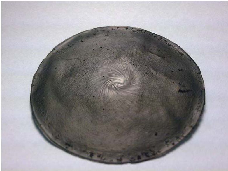
圖 3-2 Alignment 形式的巴克紙表面
