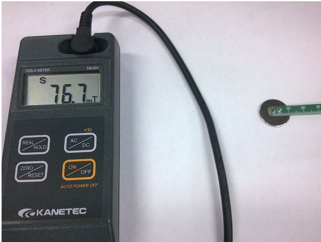
圖 4-1 TM501 量測單一鈷鐵棚結果
