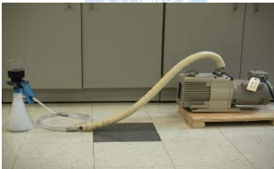
圖 2-45 機械 PUMP 過濾裝置 [105]
