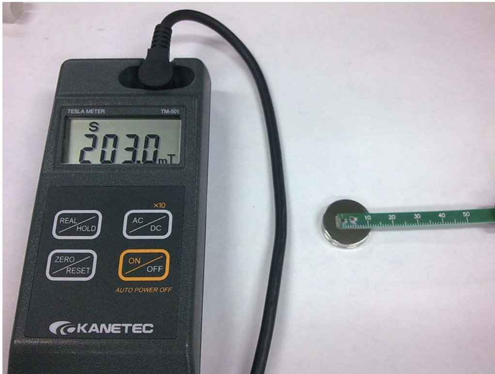
圖 4-3 TM501 量測三個鈷鐵棚結果
