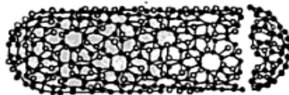
螺旋型奈米碳管 (n, m) 0^\circ < \theta < 30^\circ
