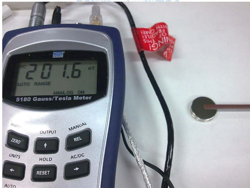
圖 4-4 5108 量測三個鈷鐵棚結果
