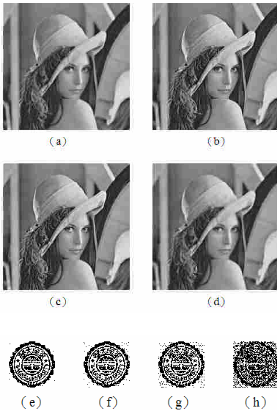
圖 4.1 JPEG 壓縮攻擊測試的結果，其中 (a) ~ (d) 為 JPEG 壓縮攻擊後的 Lena 影像，壓縮品質依序為 90%、70%、50%、20%。PSPNR 依序為 33.62、32.99、32.57、31.54；(e) ~ (f) 為 (a) ~ (d) 中取出之浮水印，其相似度 NC 值依序為 0.91、0.87、0.79、0.53。
