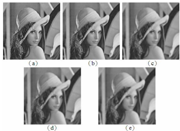
圖 4.1 JPEG 壓縮攻擊測試的結果，其中 (a) ~ (d) 為 JPEG 壓縮攻擊後的 Lena 影像，壓縮品質依序為 90%、70%、50%、20%。PSPNR 依序為 33.62、32.99、32.57、31.54；(e) ~ (f) 為 (a) ~ (d) 中取出之浮水印，其相似度 NC 值依序為 0.91、0.87、0.79、0.53。
