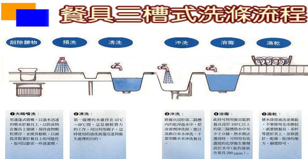
圖 3-1 餐具三槽式洗滌流程
