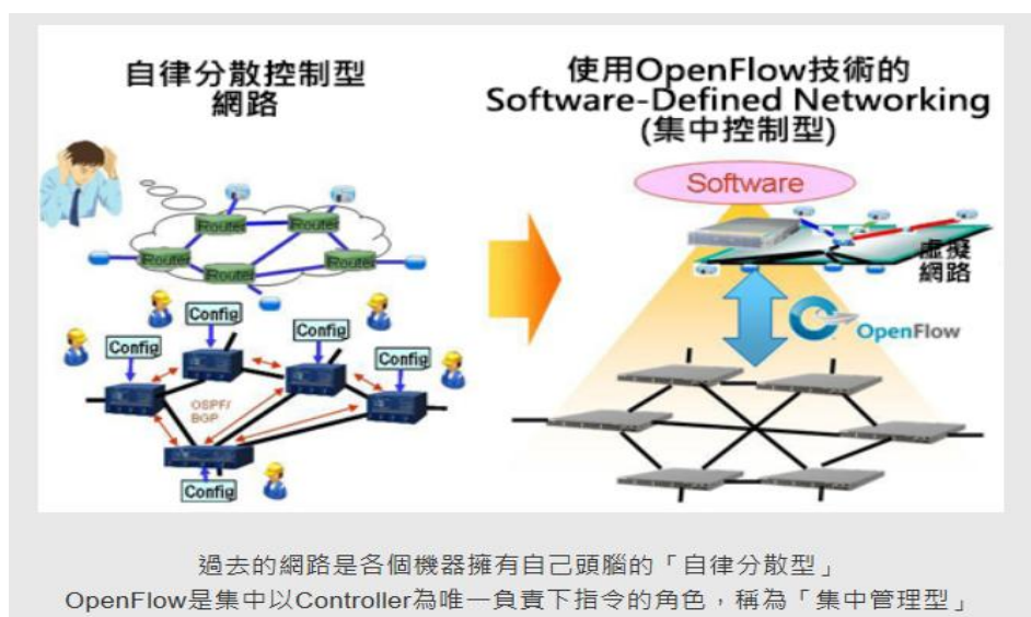
圖 1-2 : 傳統網路與 SDN 網路運作模式 資料來源 : NEC (2016)
