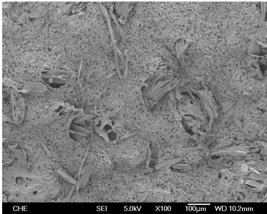
圖 4-11 以 4g 的木粉作為造孔劑，來製備多孔性的 PVF Foam，利用 SEM 觀察多孔性 PVF Foam 的表面結構(聚乙烯醇： C_{PVA}=7.0\text{wt}\% ； DP=1700 ； T_{rxn}=60^\circ\text{C} )
