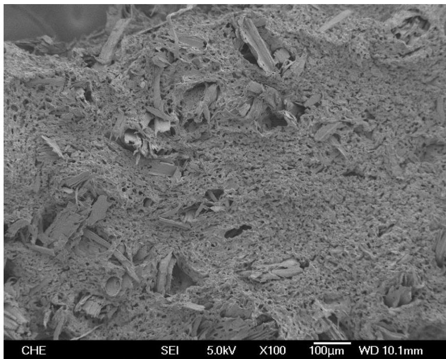
圖 4-11 以 4g 的木粉作為造孔劑，來製備多孔性的 PVF Foam，利用 SEM 觀察多孔性 PVF Foam 的表面結構(聚乙烯醇： C_{PVA}=7.0\text{wt}\% ； DP=1700 ； T_{rxn}=60^\circ\text{C} )
