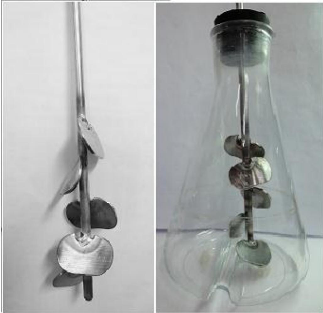
圖 12. 實驗自製不鏽鋼漿片模型。
