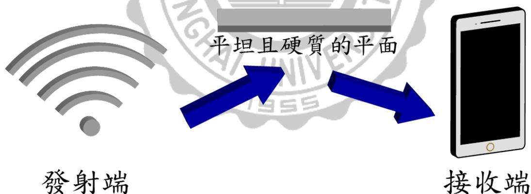
圖 3-7 無線訊號反射模擬圖
