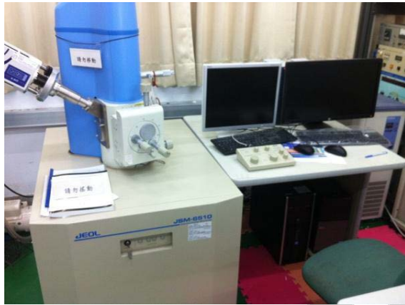
圖 3- 16 SEM 掃描式電子顯微鏡及原理示意圖
