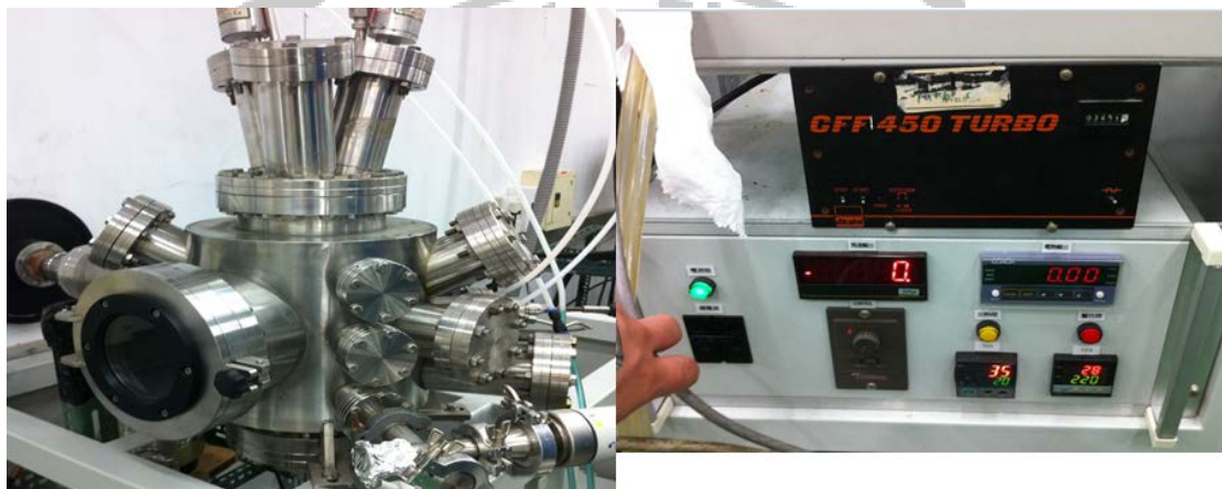
圖 3-6 高真空腔體及溫度控制器
