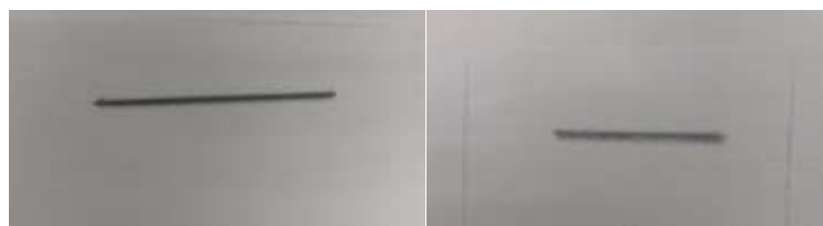
圖 3.6 電阻型態完整(左)與缺陷(右)
