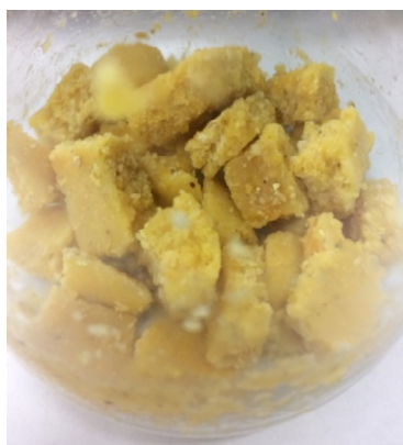
圖 4-7 基質切塊示意圖
