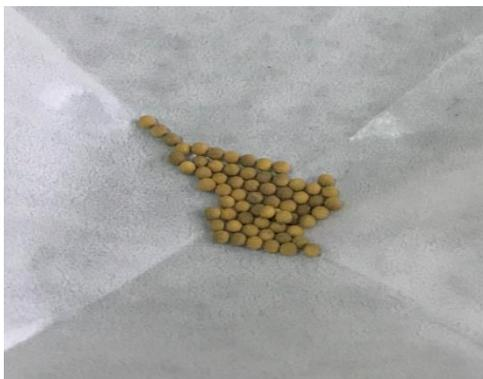
圖 3-6  $\text{Cr-Al}_2\text{O}_3$  觸媒(含浸法)
