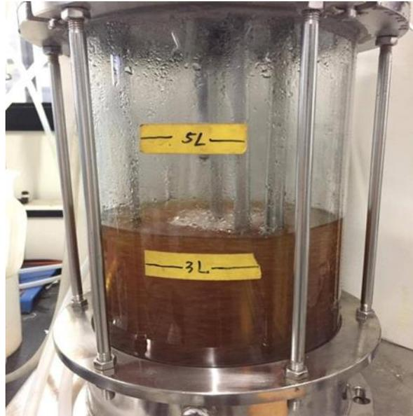
圖 4-15 攪拌式發酵槽外觀
