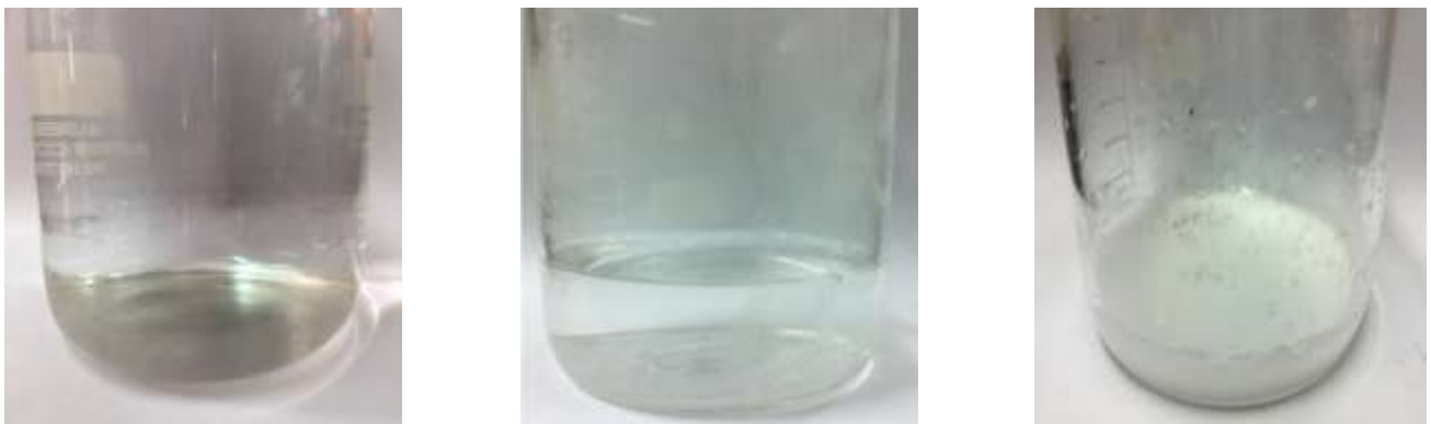
(a) DICY, 2-M 加入 MeOH 中震盪 (b) 甲醇與環氧樹脂均勻攪拌 (c) 抽氣完放至鐵氟龍前
