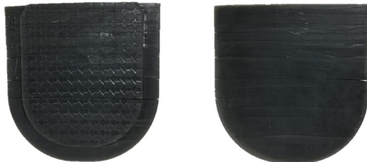
圖 54： EPX 81 樹脂所製作的入子測試射出\_第 1 模龜裂
