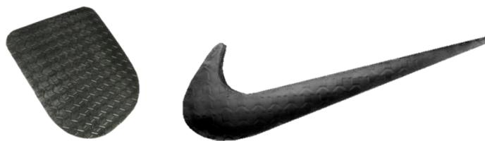
圖 65：實驗 2D Texture 射出成型品&雷射切割成品
