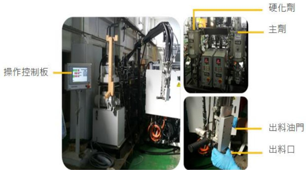
圖 42：Isotherm \_ PSM90 反應射出成型機
