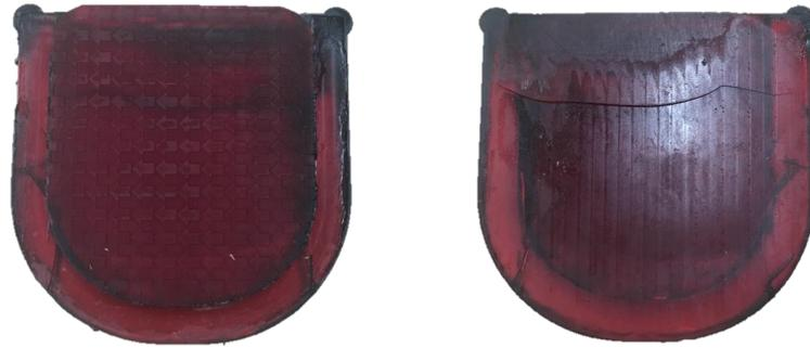
圖 55：CE 221 樹脂所製作的入子測試射出\_第 16 模龜裂
