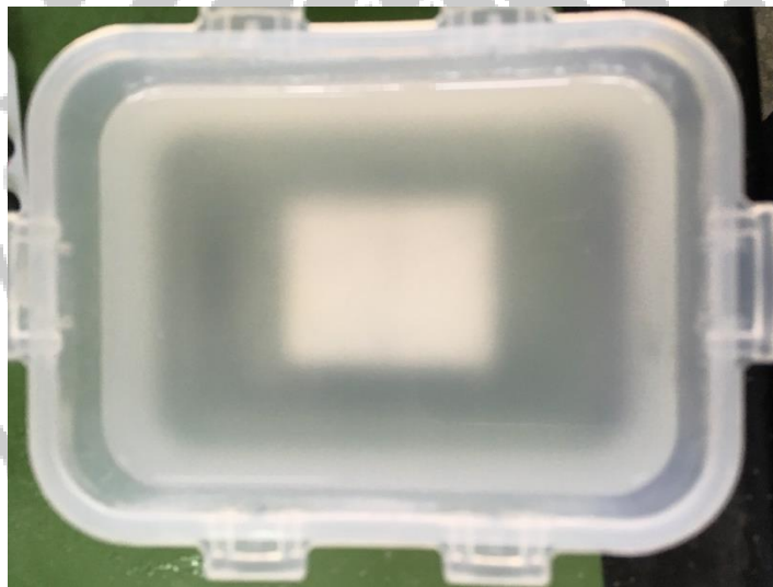
Figure B - 2 BF05 固成分為 10wt% 添加 3.0wt% 小麥澱粉在 60°C 情況下，經過 5 分鐘變化的圖。
