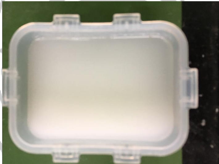
Figure B - 4 BF05 固成分為 10wt% 添加 3.0wt% 小麥澱粉在 60°C 情況下，經過 20 分鐘變化的圖。
