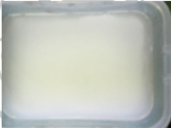
Figure B - 8 BF05 固成分為 10wt% 添加 3.0wt% 小麥澱粉在 60°C 情況下，經過 180 分鐘變化的圖。
