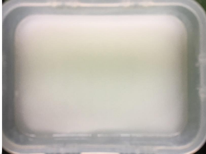
Figure B - 7 BF05 固成分為 10wt% 添加 3.0wt% 小麥澱粉在 60°C 情況下，經過 120 分鐘變化的圖。
