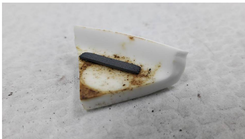
圖 3-12 長 20 mm、寬 4mm、高 1.5mm 柱狀塊材圖
