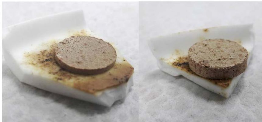
圖 3-9 直徑 15 mm，高(a) 1.5 mm 與(b) 3 mm 圓盤狀塊材圖
