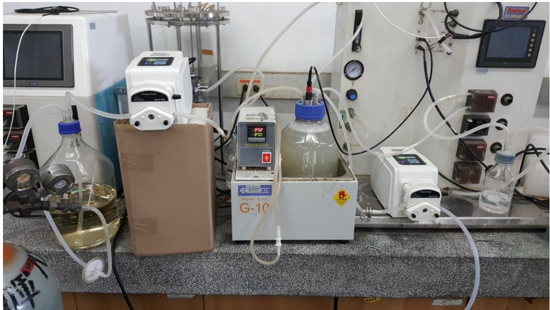
圖 3.2 5L 厭氧固定化連續式培養系統
