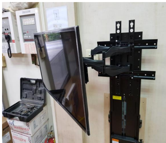
圖 5-20 螢幕掛架轉向測試
