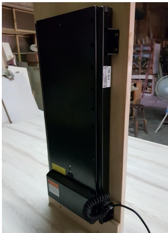
圖 5-14 測試支撐桿結構
