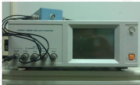
【圖 3-8】阻抗頻譜量測儀器(HIOKI 3522-50 LCR HiTESTER)。
