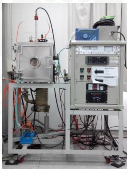
【圖 2-7】高真空直流(交流)磁控濺鍍機。
