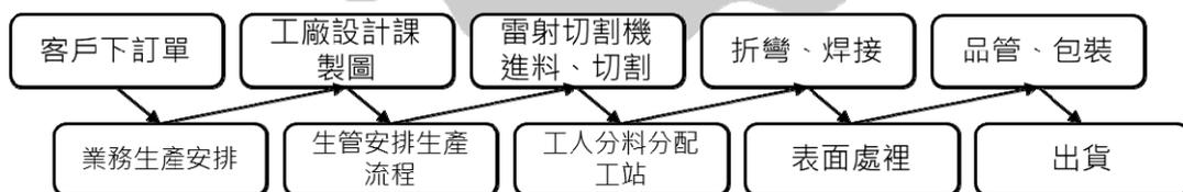
圖 1-3 製造流程
