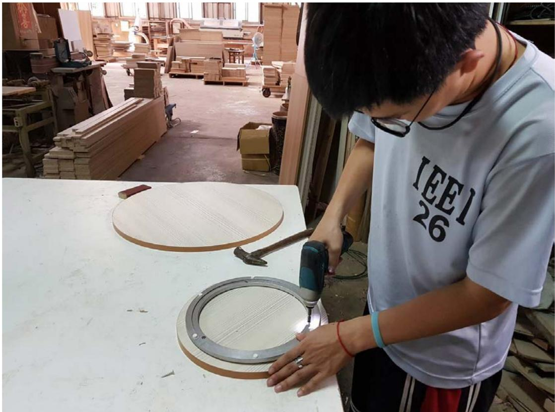
將轉盤固定在第一圓盤上，以方便使用者可以轉動。
