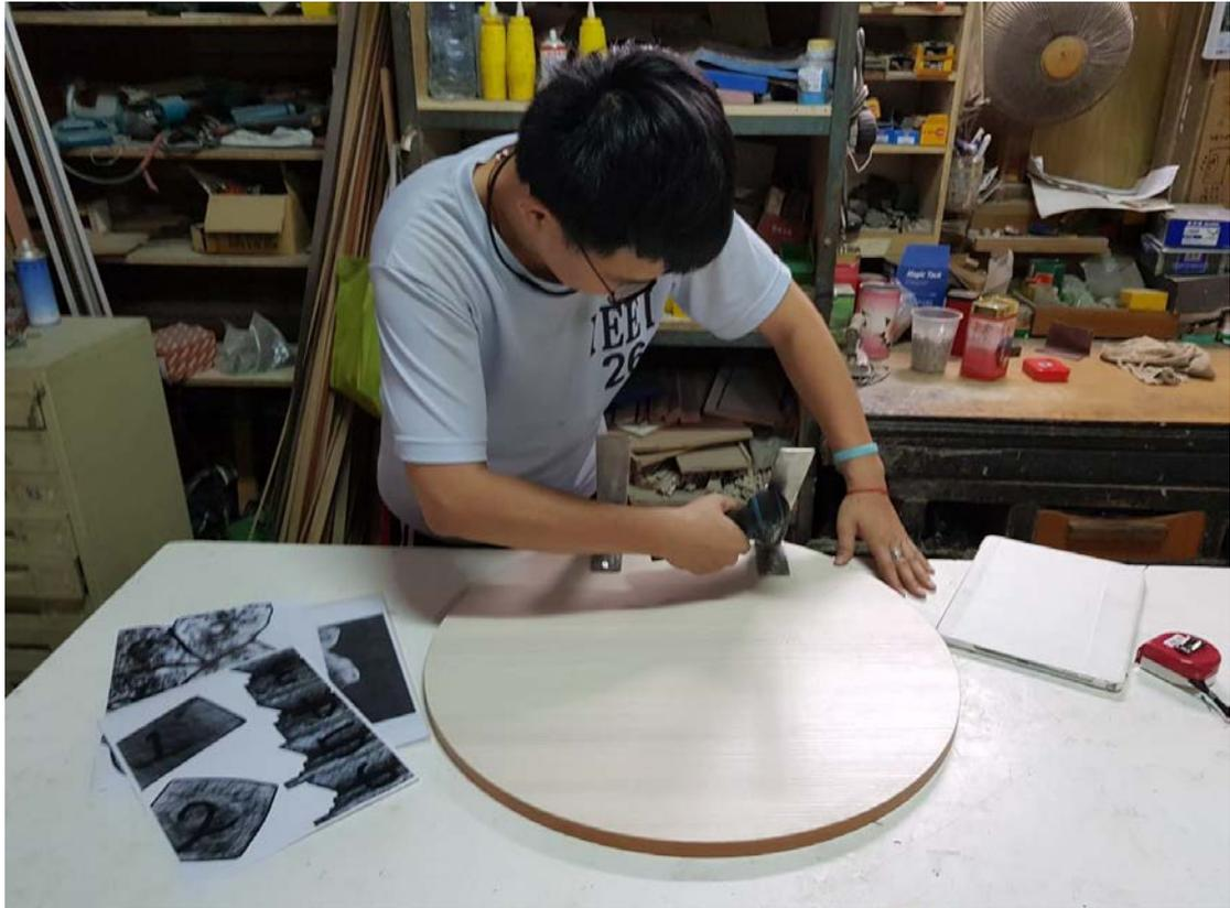
先估計預計高度以及預計距離，再將鐵支架鎖在圓盤上。
