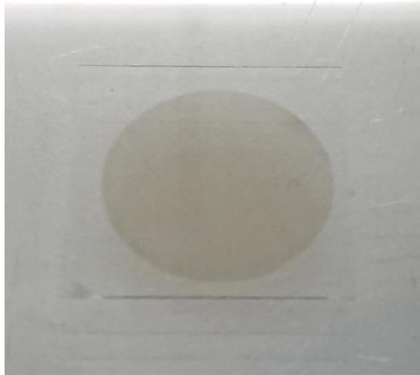
圖 3-13 利用粉體射頻濺鍍法將 MWCNTs 粉末鍍於蓋玻片上
