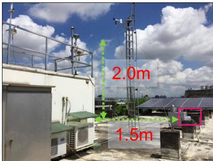
圖 2.16 可攜式智慧型監測系統架設圖
