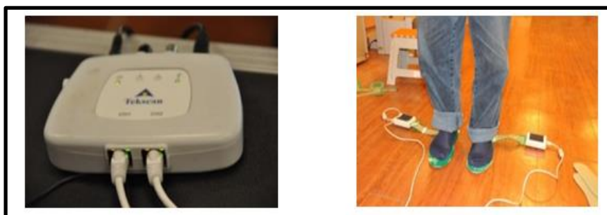
圖 3.2 Tek-Scan 接觸式足壓量測儀與壓力感測墊放置(本研究整理)
