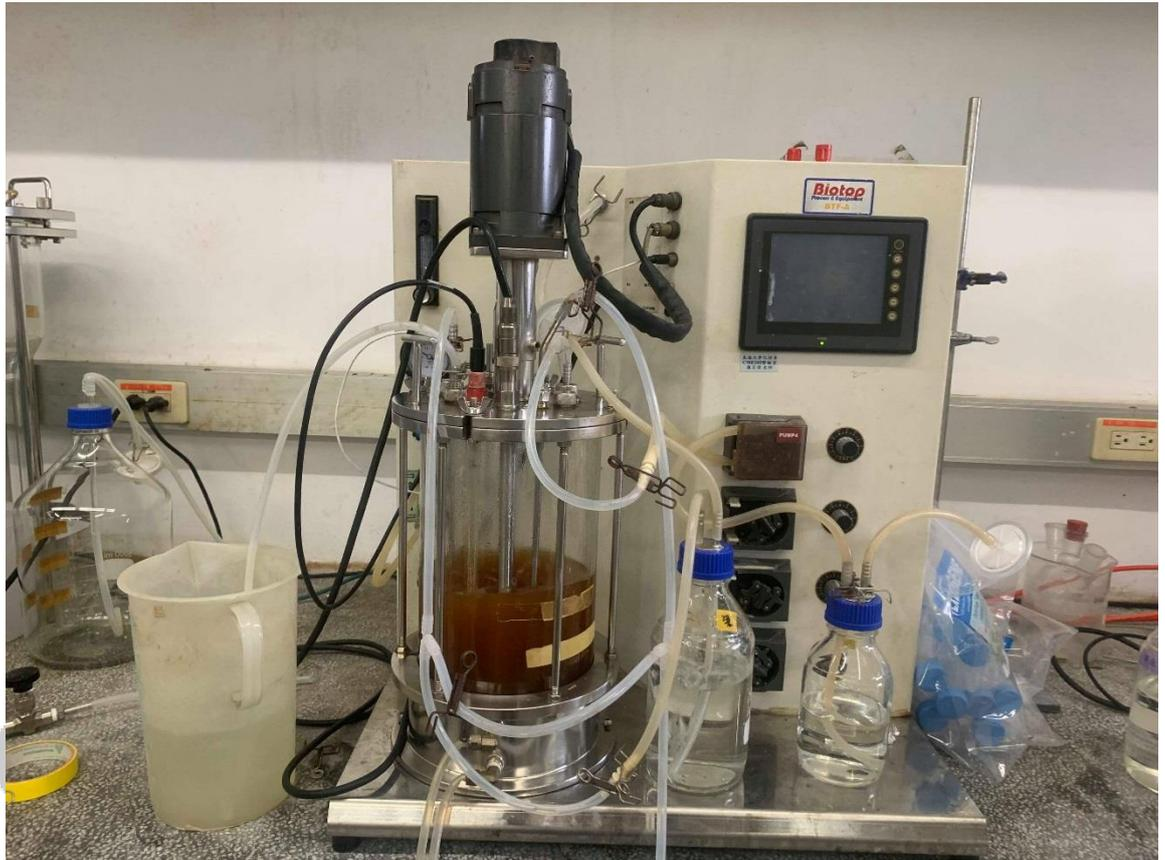
圖 3.4 5L 攪拌式發酵槽培養系統
