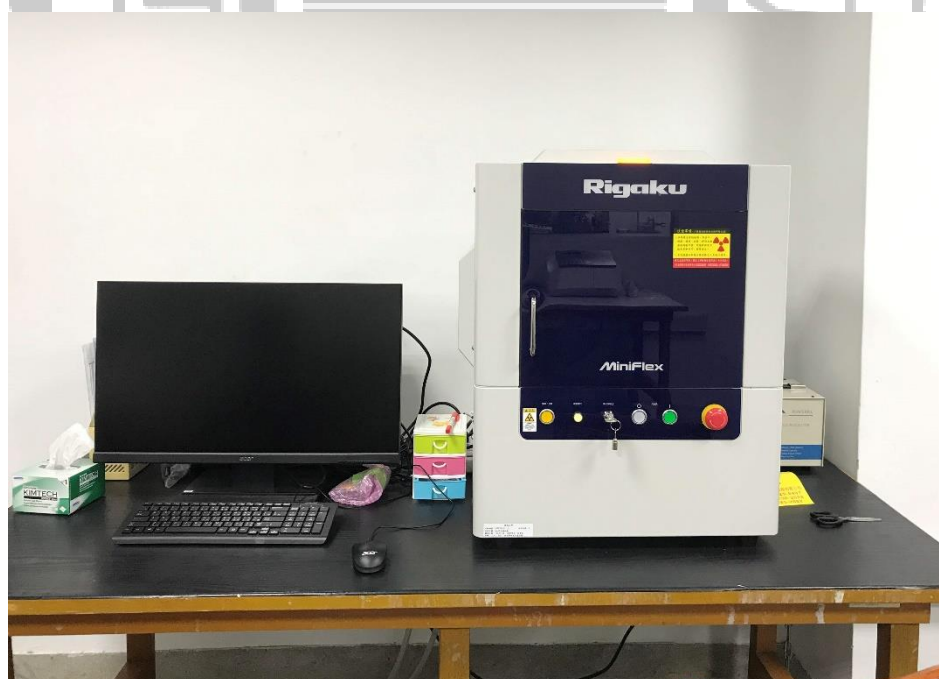
圖 3-4 Rigaku Miniflex 600 X-射線粉末繞射儀
