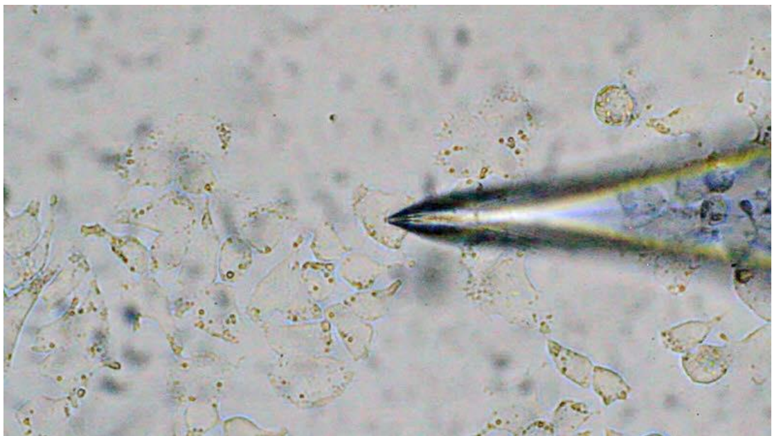
圖 3-15 嘗試以微米毛細管吸取單顆細胞 DNA。使用奈米三軸平台移動尖端開口直徑為 1\mu\text{m} 之毛細管進入細胞內，並以注射幫浦控制抽取細胞核內 DNA。
