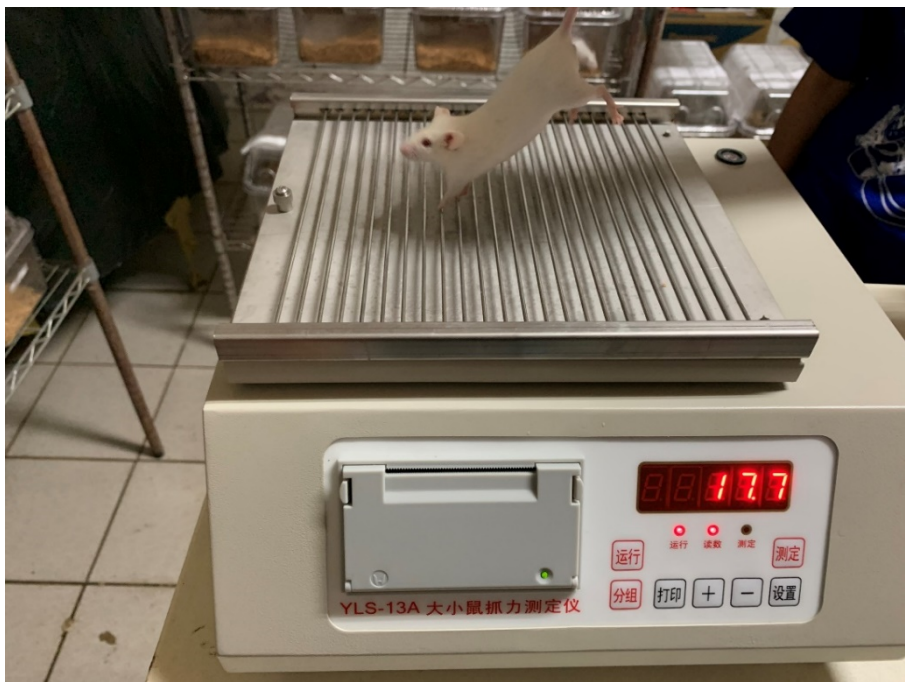
圖 八(A)、抓力測試儀 (B)、小鼠前肢抓力測試
