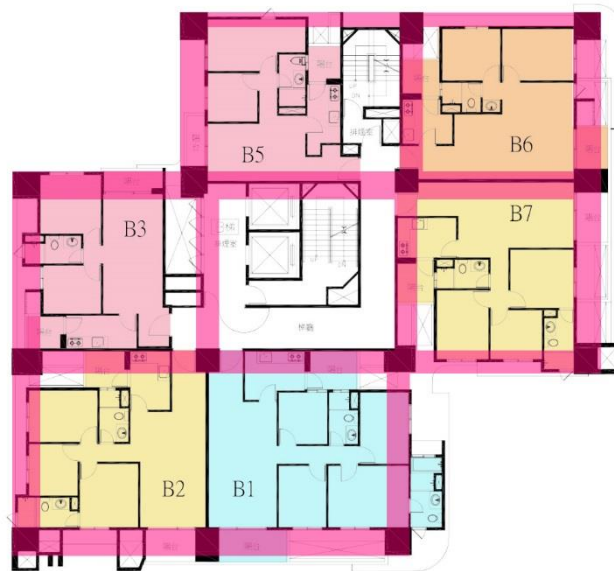
附圖-36 平面工法 梁柱外推工法 示意圖
