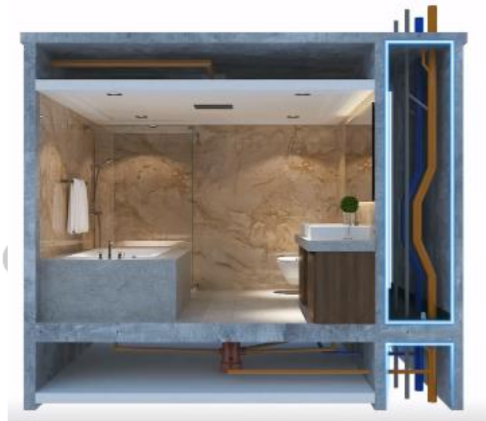
附圖-28 建築工法 管路設計工法 示意圖
