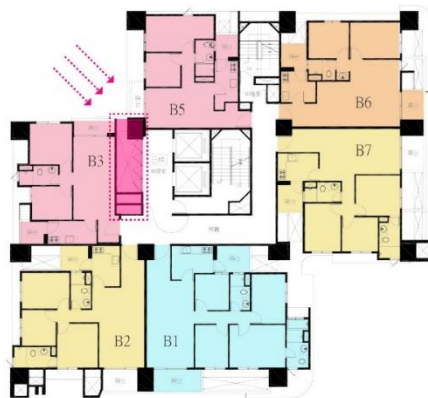
附圖-35 平面工法 梯廳引光 示意圖
