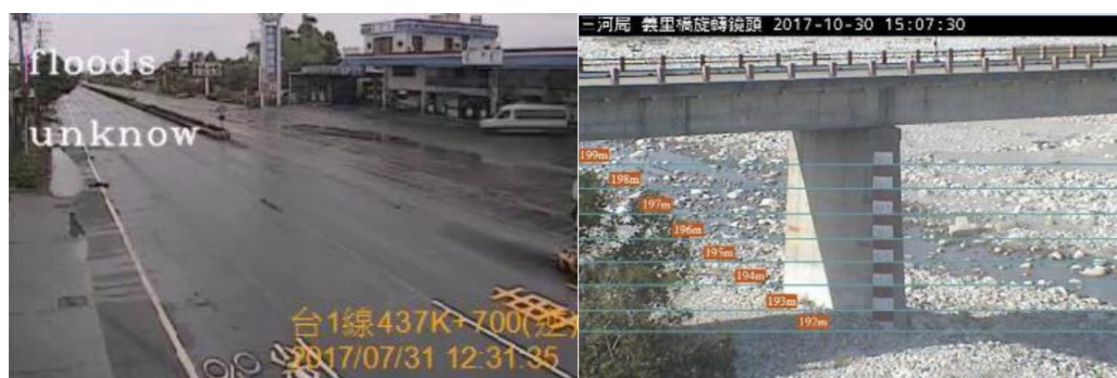
圖 4-8 深度學習-道路積水自動辨識
