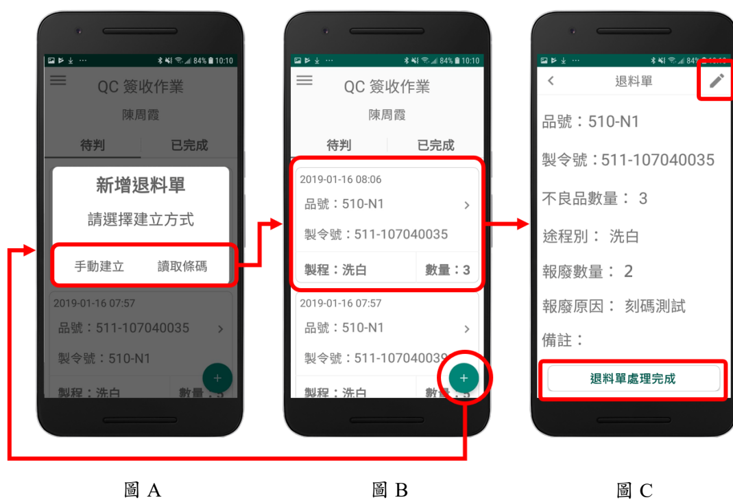
圖 4-12 圖 A 為退料單接收，圖 B 為待判列表，圖 C 為處理退料單作業
