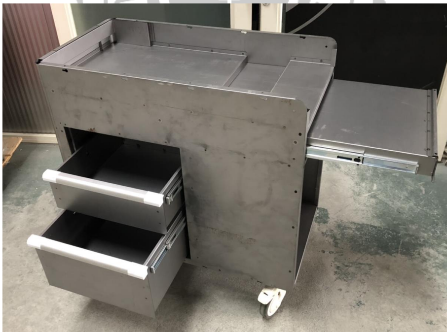
圖 5-3-1 車體材質以鐵板加工、板金、點焊
