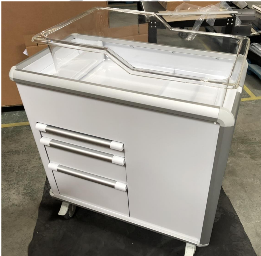
圖 5-3-3 零配件組裝-滑軌、腳輪、鋁材質、塑膠配件
