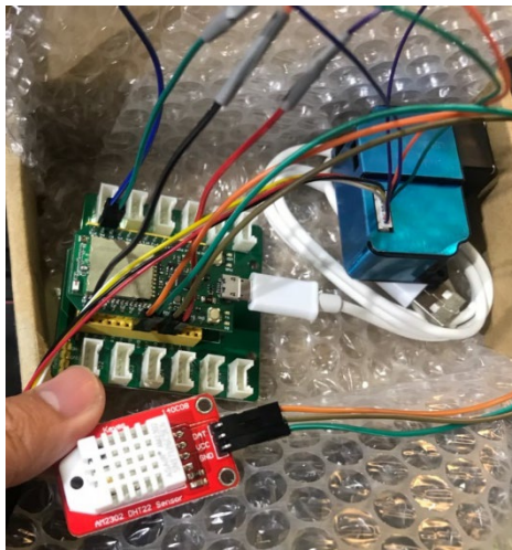
圖 4- 11 空氣汙染所需的感測器元件
