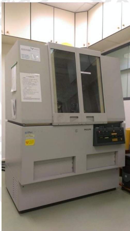
圖 3-6 東海大學共同貴重實驗儀器中心 X 光繞射儀
