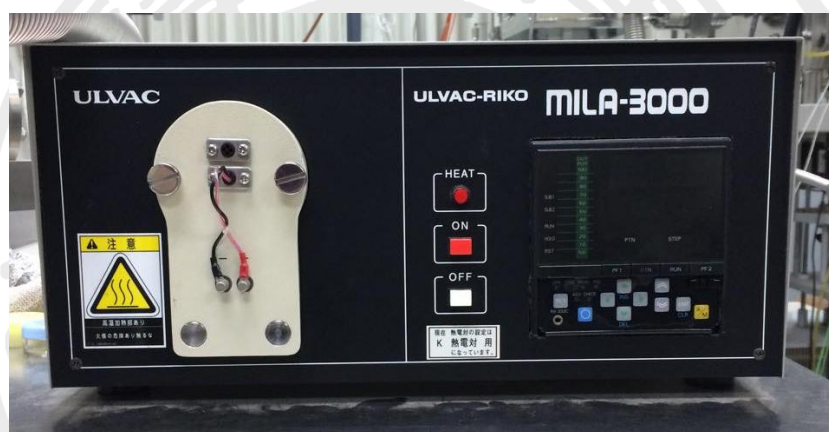
圖 3.3.1 MILA-3000 型快速升溫退火爐。
