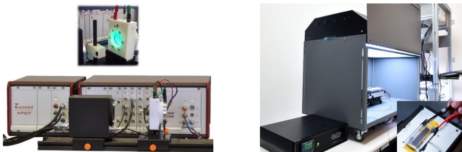
圖 1、(a)太陽能電池光電子壽命量測儀 (b)多光源低照度太陽能電池量測儀 (東海化學系精密儀器中心:太陽能電池量測實驗室)
