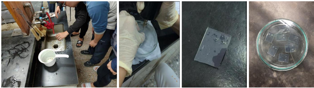
圖 16. 實作課程學生上課情形(清洗 ITO 玻璃、對電極鑽洞)
