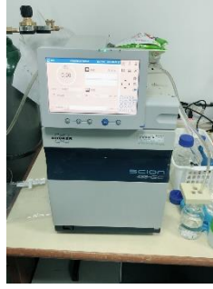
圖 4、利用氣體層析測量分析儀進行分析氣體種類與產量。
