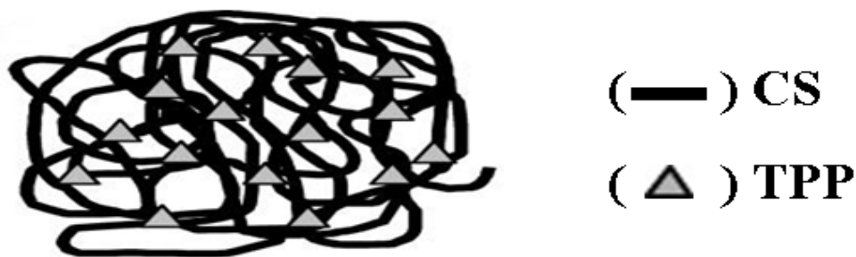
圖 2-5 幾丁聚醣與三聚磷酸鈉交聯成微粒示意圖
