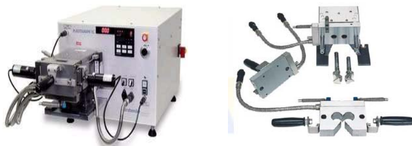
圖 3-1 塑譜儀全貌圖及轉子零件示意圖
