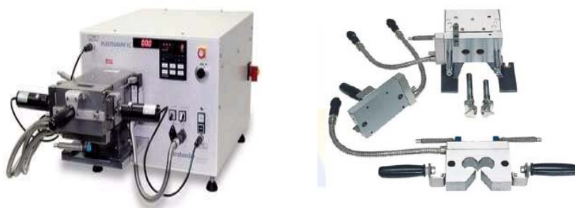
圖 3-1 塑譜儀全貌圖及轉子零件示意圖
