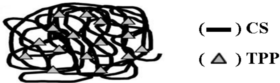
圖 2-7 幾丁聚醣與三聚磷酸鈉交聯成微粒示意圖
