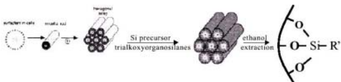
圖1-7 共縮合法的合成示意圖[2]。
