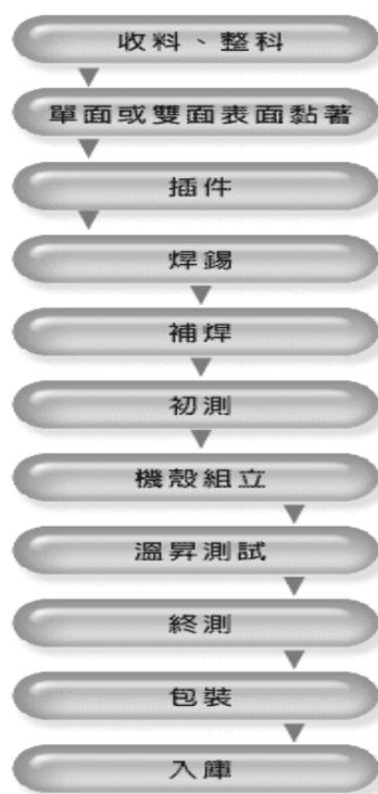
圖 1.4 一般網路通訊設備產品製程
