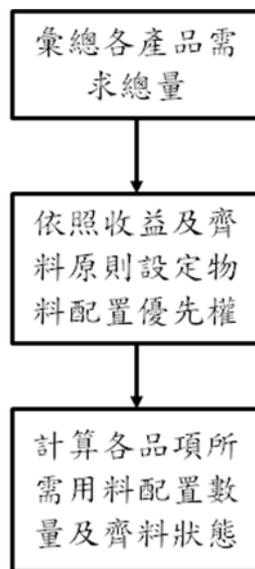
圖 3.7 priority-based 啟發式規劃示意圖
