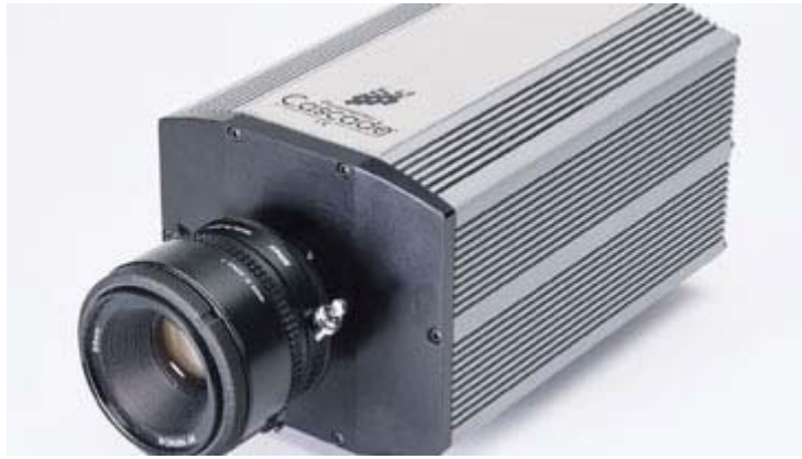
圖 2.17 EMCCD (Cascade 1K) [28]
