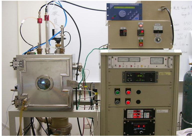
圖 2-1 高真空磁控式濺鍍系統
