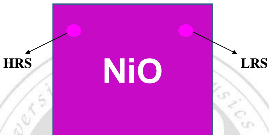
圖 4-9 用 W 針作電阻切換以便測 ESCA 之準備
