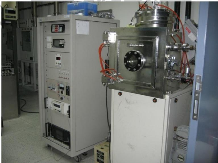
圖 2-5 電子束蒸鍍系統實體圖
