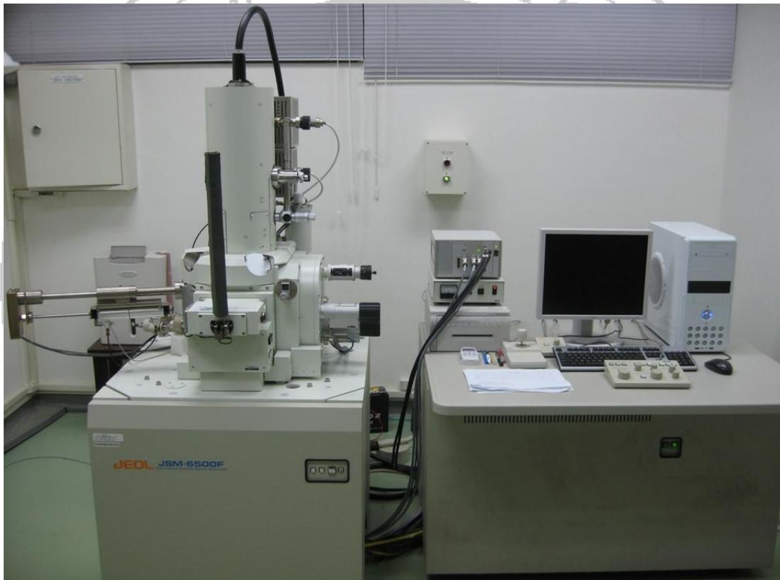
圖 2-9 熱場發射掃描式電子顯微鏡硬體圖
