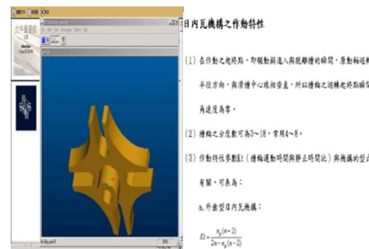
圖 21 日內瓦輪設計文件與圖面
