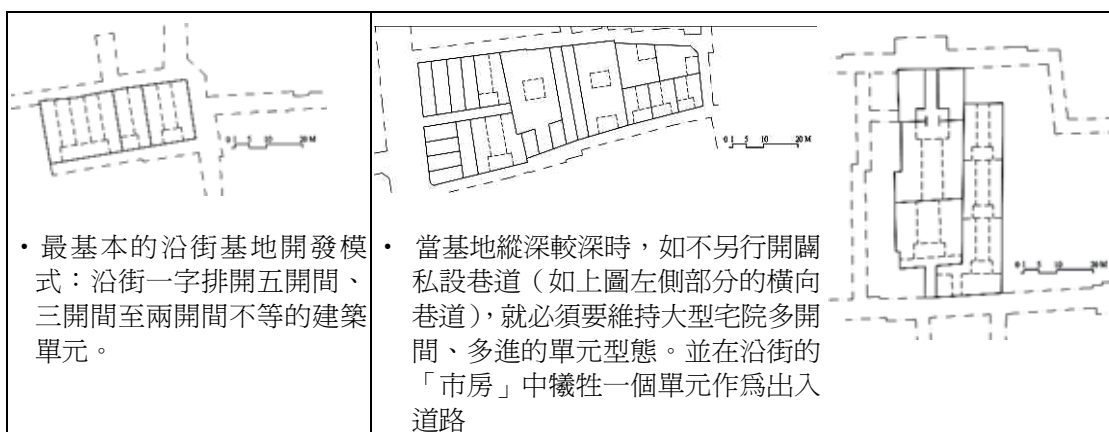
圖 7 單位基地開發時「建築線」示意圖
