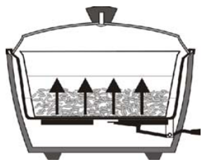
圖4 電鍋間接加熱方式及結構
