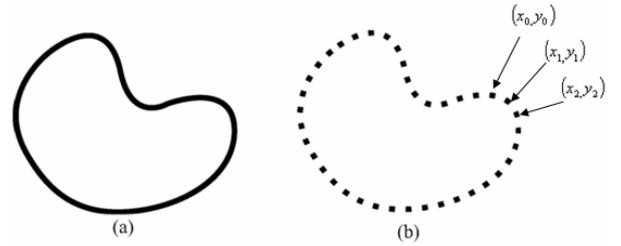
圖 2 以離散的座標資訊來呈現連續輪廓 (a) 連續的輪廓 (b) 以座標資訊所呈現的離散表示法
