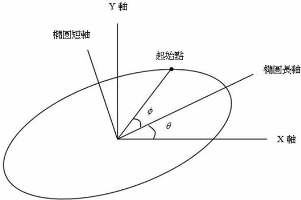
圖 4  $\theta$  為旋轉的角度， $\phi$  為相位位移的角度
