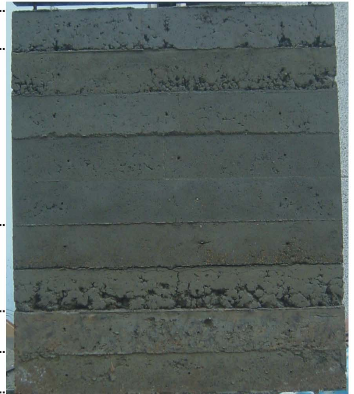
壓土測試二：有加介質增加強度，改變其物性
