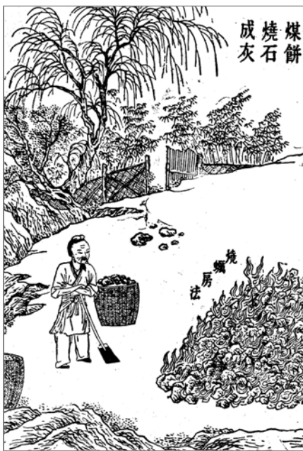
圖 3-7 將取得之礦石灰與牡蠣殼堆置，以煤餅燒製呈石灰的情形。(取自校正天工開物 p.210。)
