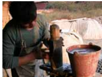
照片 3-33 上圖為大陸以腳踏製尺磚情形。下圖則為製作筒仔瓦情形。（林世超 拍攝）。
