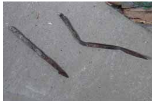
照片 2-2 固定短木柱與椽仔所使用的手工鐵釘。(照片來源：寶元)
