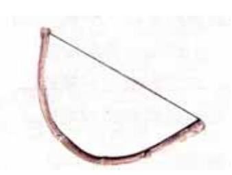
照片 3-34 上圖為磚斗仔。（取自《磚窯故鄉》1999 p.119）。下圖為切除贅土之鐵線。（取自《磚瓦之美》1997 p.66）
