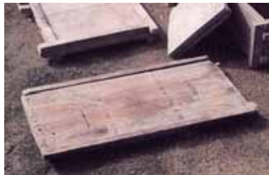
照片 3-46 養仔斗，其為製作養仔磚泥坯之模框。(取自《磚瓦之美》1997 p.66)
