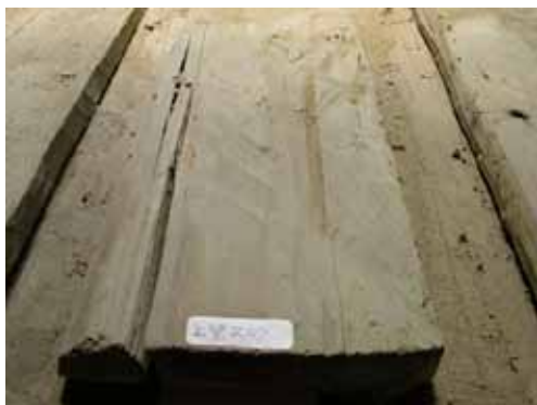
照片 2-44 清領以手工裁切之養仔板，表面留有清楚手斧修平痕跡。(照片來源：寶元)
