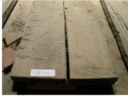
照片 2-47 電動機械裁切之養仔板，斷面為方整矩形。(照片來源：寶元)
