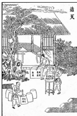
圖 3-28 製瓦時選擇無含沙的黏土，以人力或獸力將黏土練成熟泥，已鐵線切過取下製瓦所需厚度。(取自《校正天公開物》1935 p.143)。
