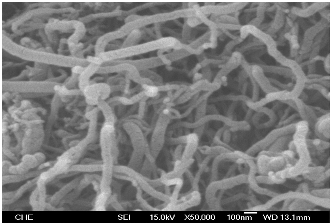
圖 3-1-18 酸處理後 MWCNTs 之 SEM 圖譜
